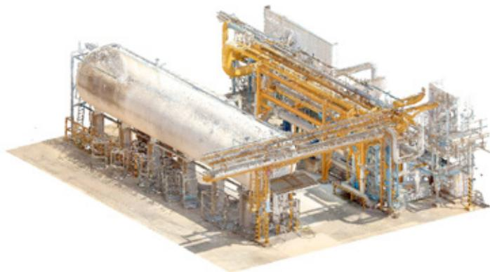
Figura 4 - Scansione 3D in impianto [Fonte: 3Units Technologies, WESCAN Solutions, 2023]
