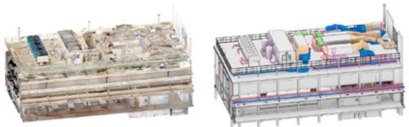
Figura 3 - Nuvola di punti da mobile laser scanner - Modello As-Built [Fonte: 3Units Technologies, WESCAN Solutions, 2023]
